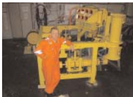
16” PSS kjøreramme, med sylindre og guide funnels
