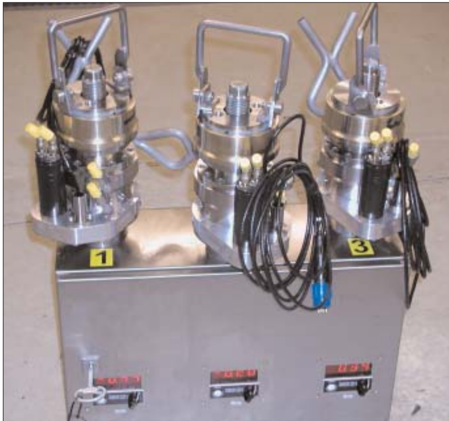
Bildet over viser jekkene montert på test/verifikasjonsenhet.
