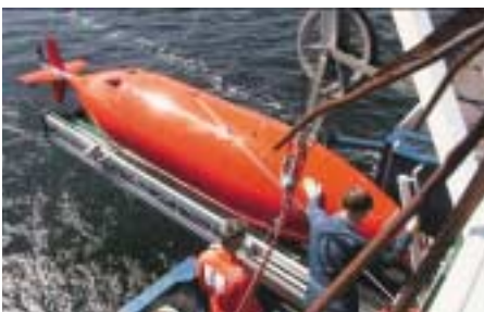
Hugin blir her tatt opp sjøen, en kritisk operasjon for en AUV
